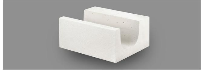
U-БЛОК bauroc изготавливается из блоков bauroc, в которых вырезается «желоб» с U-образным профилем. U-блоки используются для создания бетонных поясов, увеличивающих жесткость зданий, а также в качестве опорных участков под балками перекрытий, мауэрлатами и панелями. U-БЛОКИ подходят для изготовления монолитных бетонных перемычек на строительном объекте.
