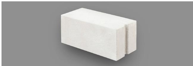
Блоки **bauroc CLASSIC** - это легкие блоки прочностью на сжатие 3,0 МПа. **bauroc CLASSIC** широко используется в строительстве. Блоки подходят для возведения как несущих, так и ненесущих внутренних и наружных стен. Благодаря низкой теплопроводности возведенные из блоков **bauroc** наружные стены всегда будут иметь лучшую теплоизоляцию, чем стены такой же толщины из любого другого каменного материала.
