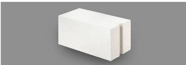
Блоки **bauroc HARD** являются строительными блоками с прочностью на сжатие 5,0 МПа. Блоки **HARD** используются для возведения стен с повышенными требованиями к несущей способности. Блоки **HARD** можно использовать и для возведения стен подвалов. Наружные стены из блоков **HARD** нуждаются в дополнительном утеплении.
